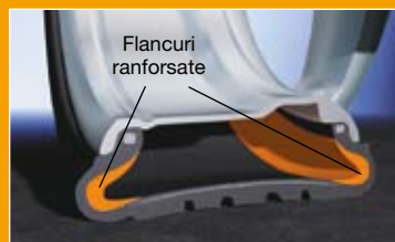
Anvelopele SSR: rularea poate continua pe o distanță de până la 80 km cu o viteză de maximum 80 km/h.
