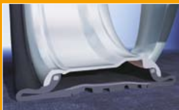
Anvelopa convențională la presiunea zero: anvelopa se deteriorează imediat.
